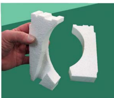
Pripremite stiropor izolaciju za stranu sa kaišem za podizanje
