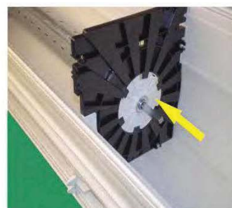
Einsatz Kopplung in Doppelkopfstück einsetzen
