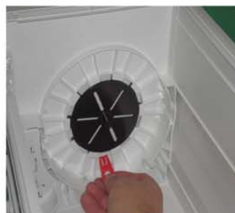
Fiksirani ležaj zaključajte umetanjem crvenog ključa
