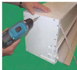
Blenden mit Kopfstücken verschrauben
