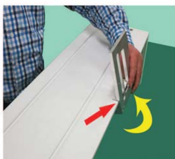
Frässhablone auf Deckel- blende positionieren Šablonu frezanja postaviti na blendu poklopca
