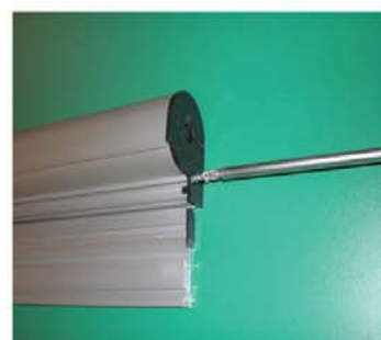
Zašarafite poklopac sa kočnicom za zaštitu
