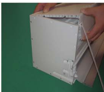
Dodajte unutarnji i donji profil na kutiju
