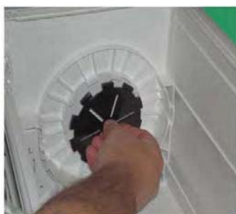
Lagerscheiben in Kopfstücke einsetzen und drehen
