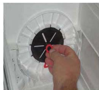
Distanzring für Mini-Gurtscheibe auf Lagerzapfen schieben
