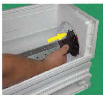
Walzenkapsel in Lagerscheibe teleskopieren
