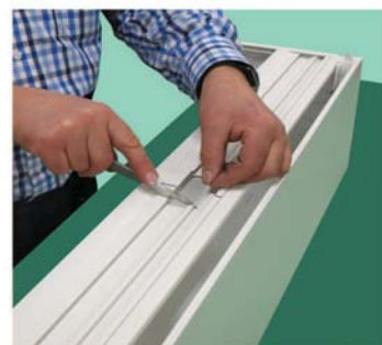
überstehenden Grat entfernen Višak brida ukloniti
