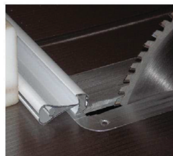
Zugschiene Tür zuschneiden Skrojiti vlačnu tračnicu
