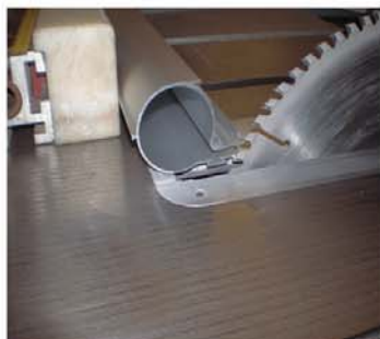
Odrežite zaštitu komarice na željenu dužinu
