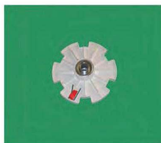
Kugellager beidseitig in Einsatz Kopplung eindrücken
