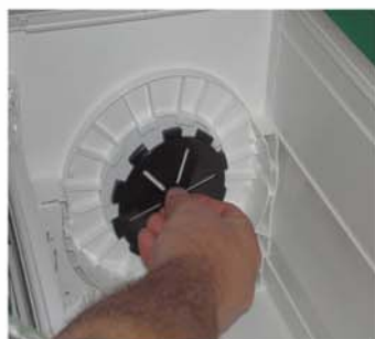
Dodajte nosač ležaja, stavite ga u poklopac i ok- renite za fiksiranje
