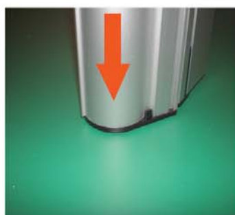
Pogurajte sa obje strane da dobro nasjedne u žljebove (ako ide zaštita)
