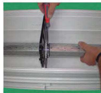
Doppelwellenbolzen durch Schraube sichern
