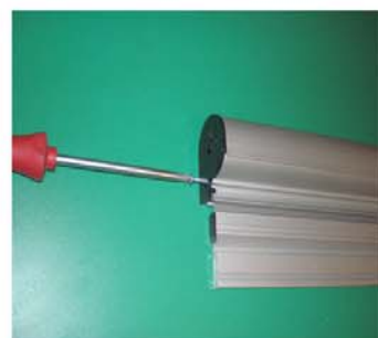
Gurnite poklopac sa oprugom u komaricu i zašarafite (ako ide zaštita)
