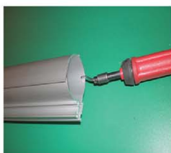
Očistiti ulaz zaštite komarice
