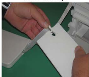
Postavite uvodnik kaiša u predhodno pripremljeno mjesto u donjem profilu
