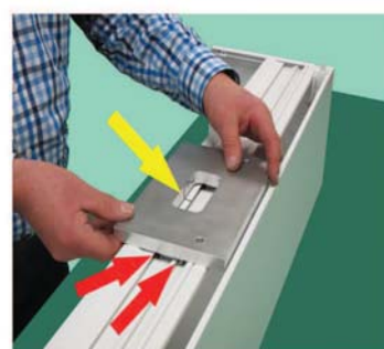
Frässhablone auf Basisbrett einrasten Uklopiti šablonu frezanja na osnovnu dasku
