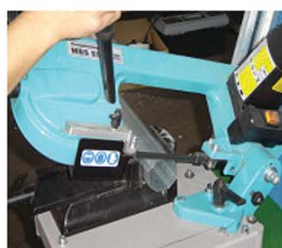
Rezanje osovine (70mm kraća) od prozora
