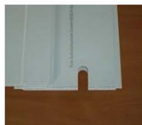
Izgled ufrezanog dijela podnice za uvodnik kaiša
