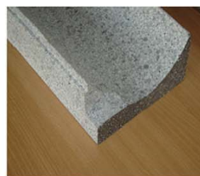
Isjeći izolacijski stiropor
