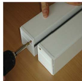
Šarafiti pvc čepove na dno vodilice
